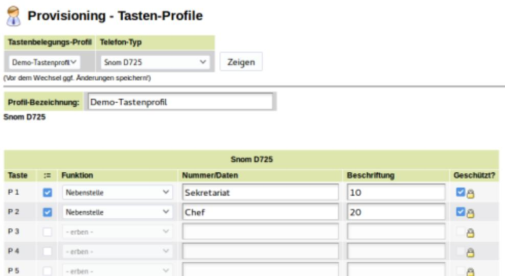
Als Nutzer mit Administrationsrechten unter *Provisioning* → *Tasten-Profile* ein Tastenprofil anlegen und die Tasten für den gewünschten Telefentyp belegen. Das Beispiel zeigt ein Tastenprofil für ein Snom D725, das die ersten beiden Tasten der Telefone vorbelegt. Wird das Häkchen bei *Geschützt?* gesetzt, kann der Nutzer diese Tasten später nicht überschreiben.
