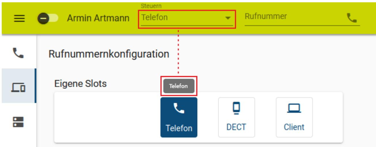
Der Name eines Slots wird als Tooltip über der zugehörigen Schaltfläche angezeigt und steht in der Kopfleiste unter **Steuern** zur Auswahl.
